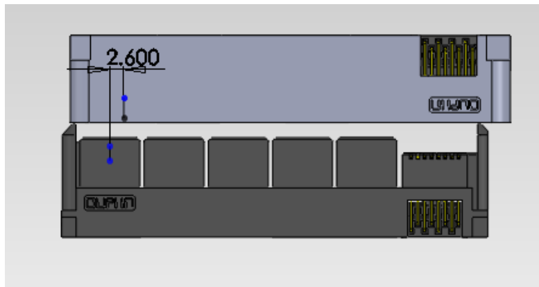
allowed misalignment in longitudinal axes 在縱向方向允許對插偏差量
